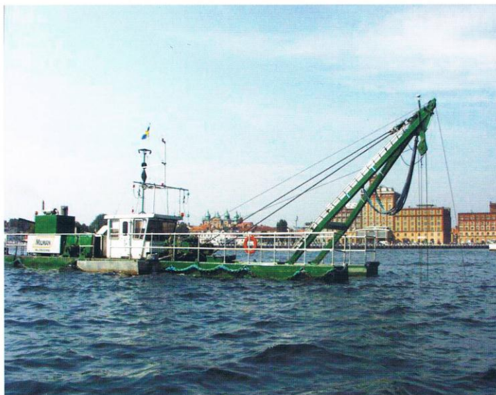
Mudderverken har mycket hög precision, minimal uppgrumling och låg vatteninspädning som specialitet
