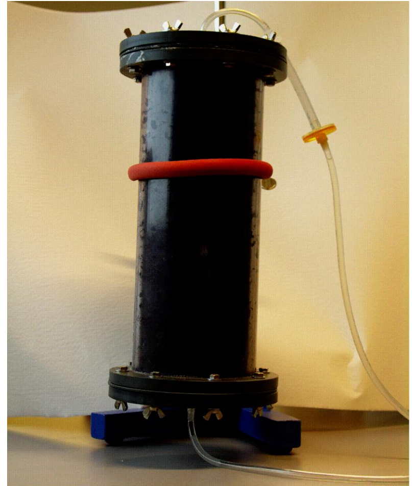
Kolonn vilken används vid perkolationsstestet
