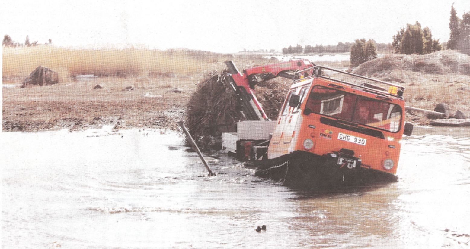
Per Nilsson, som även kallas "Kalix" har köpt en bandvagn som han byggt om till sitt arbetsfordon. Bandvagnen är helt tät i underredet och då den är bra på att ta sig fram i svår terräng kan den användas till att köra på botten i en halv meter högt vatten.
