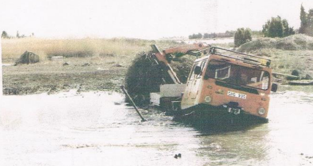
Per Nilsson, som även kallas "Kalix", har köpt en bandvagn som han byggt om till sitt arbetsfordon. Bandvagnen är helt tät i underredet och då den är bra på att ta sig fram i svår terräng kan den användas till att köra på betten i en halv meter högt vatten.
