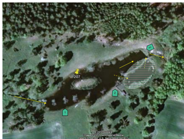
Figur 3. Ön är anlagd som en smal gångpassage med en planterad trädallé och har två bryggor i båda ändarna. Bryggorna tillåter vattenpassage (ca 1-1,5 m), men öppningarna är för trånga för att en större del av vattenflödet verkligen skulle kunna ta den vägen.
