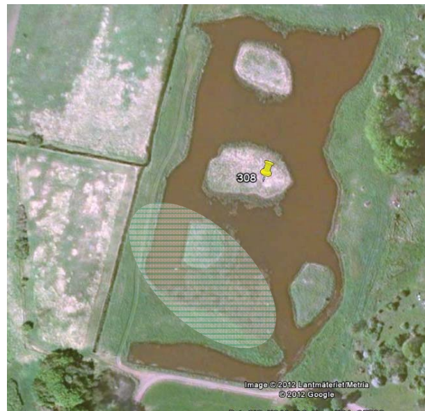
Figur 6. Restvegetationen i kombination med placeringen av öarna och våtmarkens fyrkantiga form utgör numera istället en risk för döda zoner utan nämnvärt genomflöde och innebär därför en starkt nedsatt hydraulisk effektivitet i våtmark 308.
