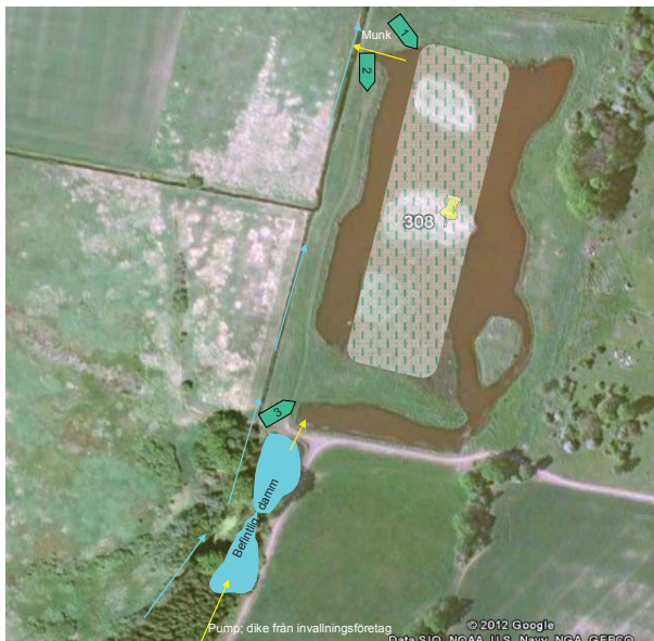
Figur 5. Våtmark 308 vid Vassmolösa. Ursprungligen var det tänkt att allt vatten skulle passera ett tätt band av vegetation i mitten av våtmarken (streckade ytan).
